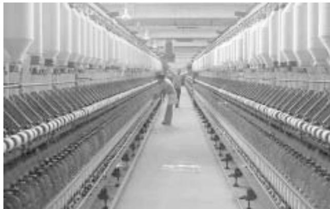
No setor de tecelagem, o trabalhador é encarregado de identificar os rompimentos na trama do tecido e emendar os fios. A máquina não possui altura regulável exigindo manutenção da postura de pé com flexão de tronco. No desenrolar da tarefa é necessário manter os membros superiores elevados com flexão de ombro de aproximadamente 90° (Figura 2).
